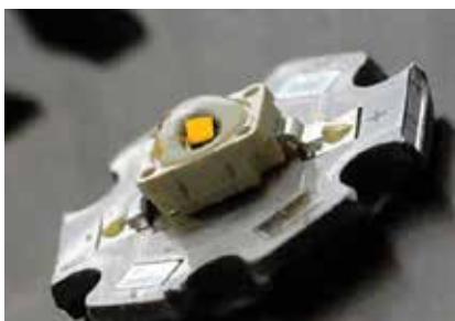
Figura 2. LED chip pegado sobre un disipador de calor de aluminio
