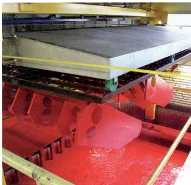
Fig. 3: Baño de electrodeposición de Grimme en su planta de Damme
