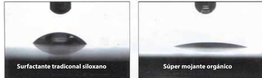
Figura 5. Mojado de un surfactante siloxano tradicional, versus un súper mojano orgánico 0,1 % en peso en solución acuosa, sobre una superficie metálica aceitada, 10 seg. de mojado, 23 °C
