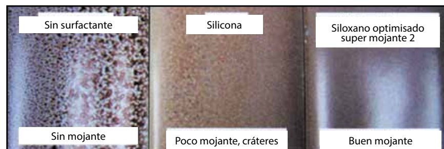
Figura 9. Poliuretano 2K base agua aplicado sobre paneles de polipropileno.
