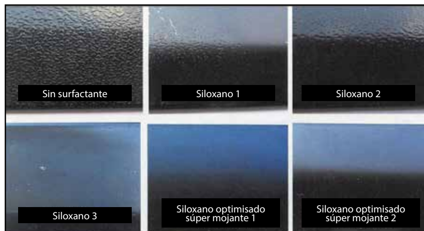
Figura 8. Poliuretano 2K base agua aplicado sobre paneles de polipropileno.
