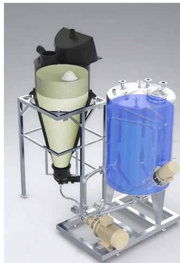
**Figura 4:** Pasos del proceso para la dispersión optimizada de dióxido de titanio en la producción de pintura para paredes.
