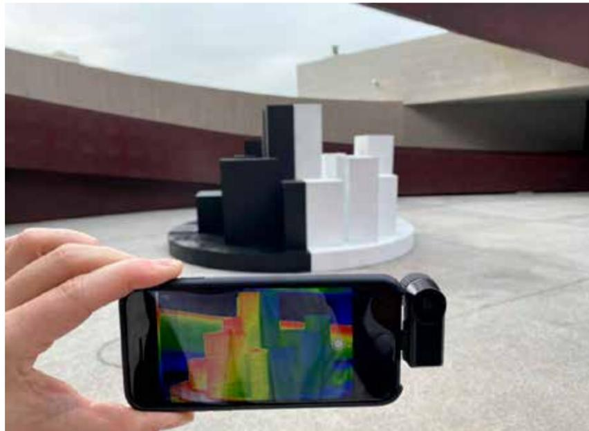
Una cámara termográfica captura las diferencias de temperatura entre los modelos negros y los pintados con el El Blanco Más Frío.
