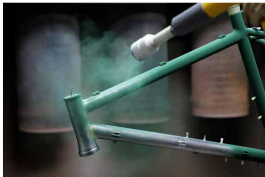
pecto al nivel de la temperatura en que el polvo se aplicará, ésta varía según el espesor de recubrimiento deseado.
