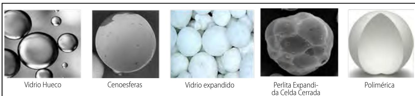
**Figura 1:** Tipos de cargas ligeras / microesferas
