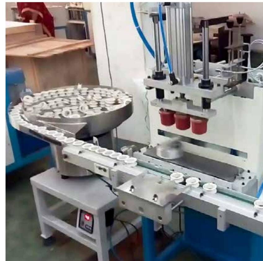
**Figura 11.** Impresora tampográfica automática.
