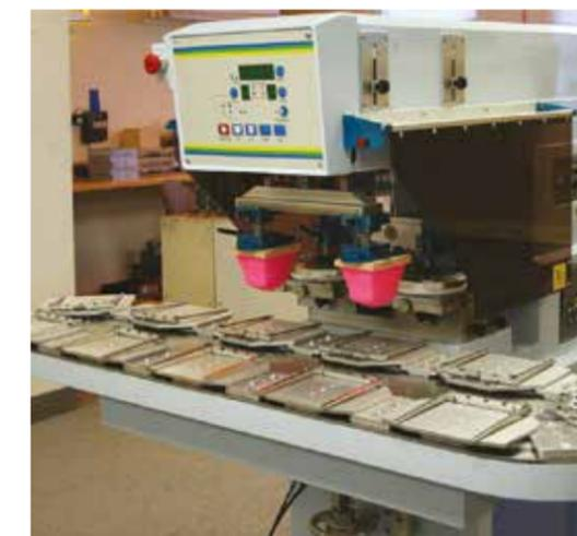
Figura 6. Impresora a dos colores con un carrusel de 11 estaciones.
