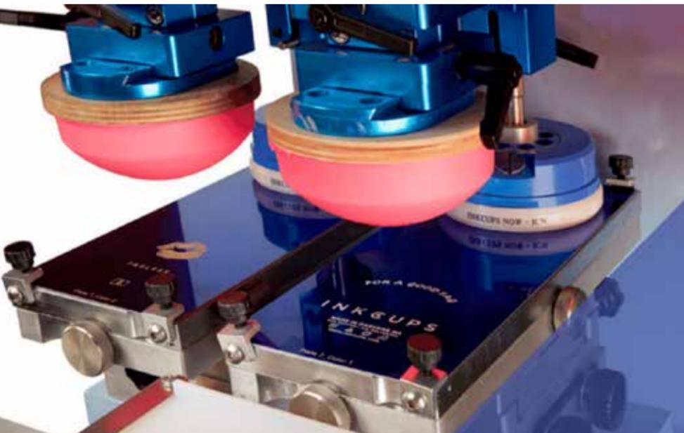
**Figura 7.** Impresora tampográfica con tampones móviles y sustrato fijo en una platina.
