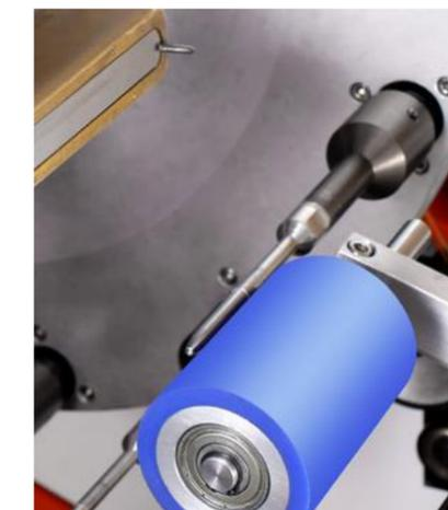
Figura 5: Tampones cilíndricos.
