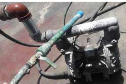
Bomba Neumática de 2" y lanza, para lavado de tanques con el agua clarificada
