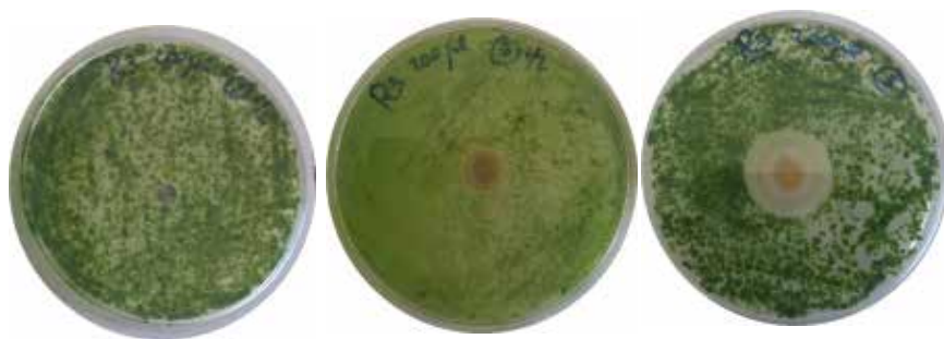
Figura 4. Resultados de ensayos de difusión en placa: a) actividad biocida nula, b) actividad biocida baja, c) actividad biocida alta.
